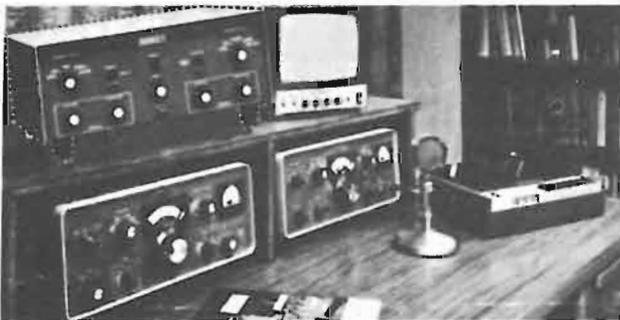
Fig. 4 - I convertitori analogico-digitale con memorie di centinaia di chilobit sono costosi, però semplificano parecchio i problemi connessi con la trasmissione e ricezione della SSTV. Se nella stazione SSB vi è un registratore-audio a nastro ed un televisore normale; le uniche parti aggiunte sono: la Telecamera ed il Convertitore.
